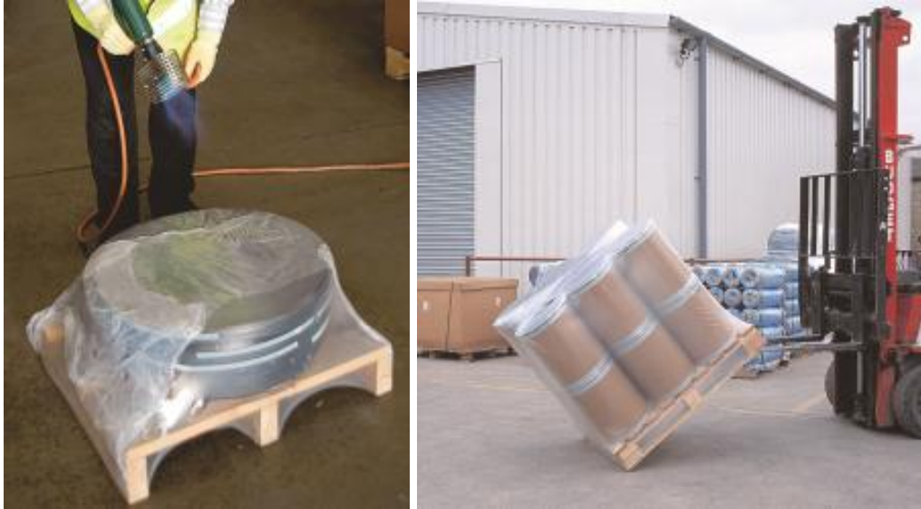
Şekil 5 – Polietilen palet kaplama uygulaması ve kaplamanın dayanıklılığı
